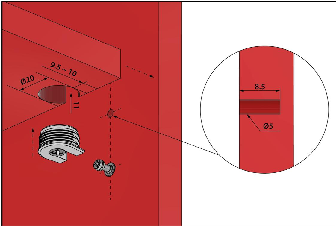
**Wygodne dokręcanie poprzez ustawienie śrubokręta pod kątem  $25^\circ$  /**
