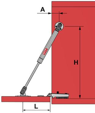
**Waga drzwi w zależności od siły podnośnika i wysokości drzwi (dla kąta 90°)**
