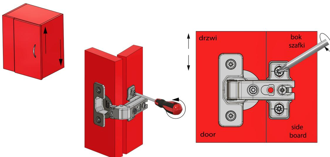
Regulacja wysokości / Height adjustment
