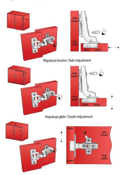
Regulacja wysokości / Height Adjustment
