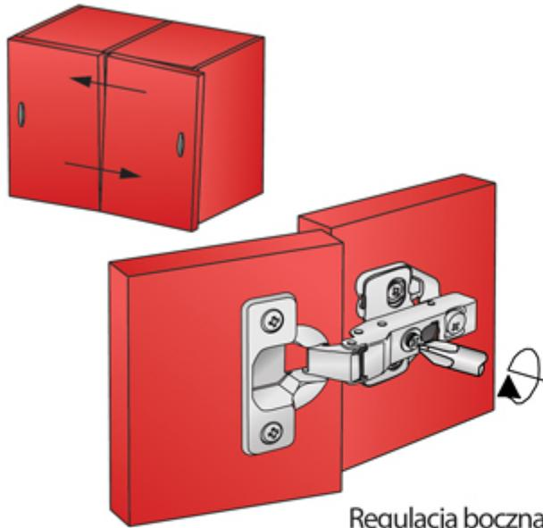
Regulacja boczna / Side adjustment
